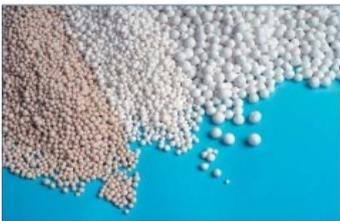
Queste sostanze, molto porose e chimicamente inerti nei confronti dell'aria da essiccare, hanno la proprietà di adsorbire il vapore acqueo presente nell'aria compressa, prevenendo fenomeni di corrosione, formazione di particelle inquinanti, danneggiamento ai componenti pneumatici ed interruzioni della produzione.
